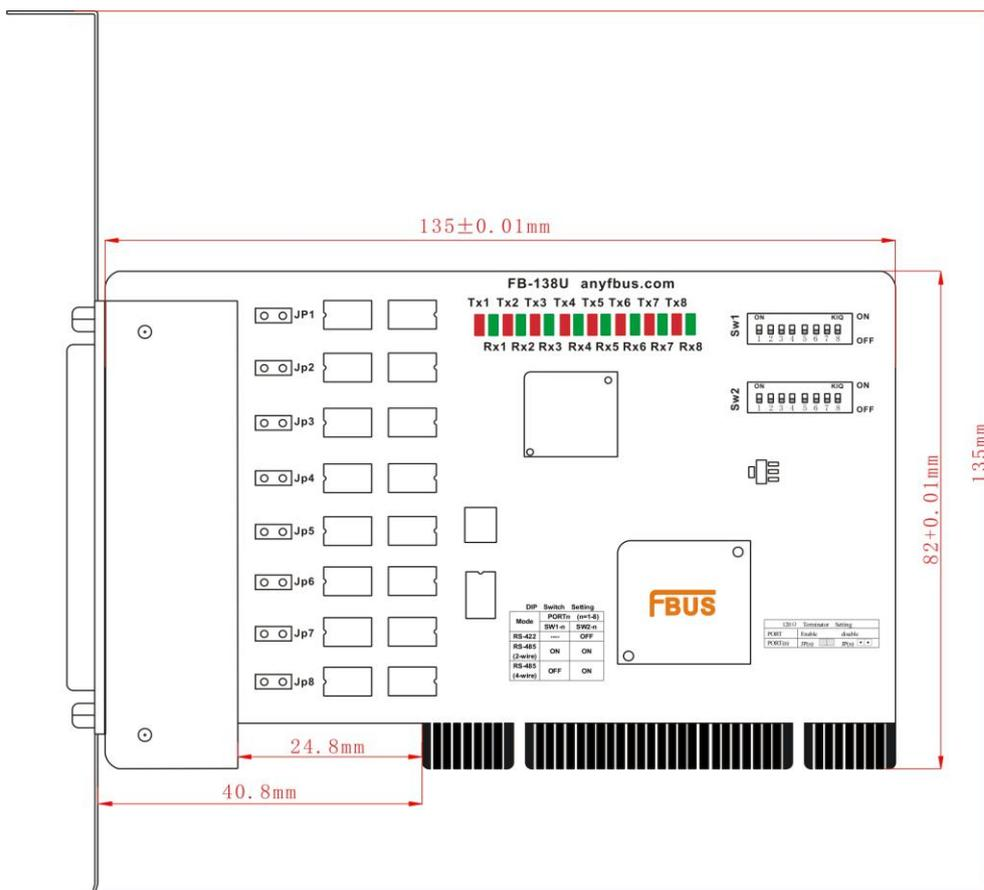
利用跳线JP1至JP8为每个串口单个激活终端电阻（120Ω），JP1对应串口1，依次对应。短接跳线引脚，终端电阻被激活，反之，终端电阻闲置。
