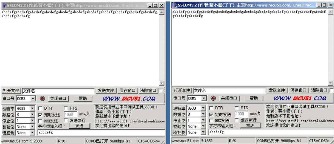
3. 依照前两个步骤对其他串口两两测试，如收发数据均正常，表示多串口卡安装成功，可正常使用。
