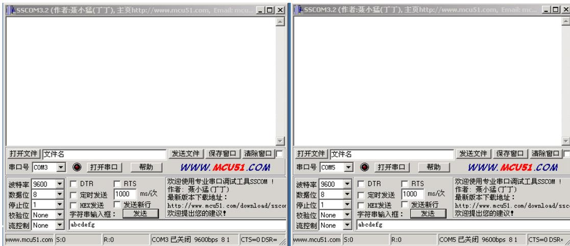
2. 可同时选择定时发送，两串口之间同时互相发送数据（2线RS-485模式不能同时发送），观察收发数据是否正常。
