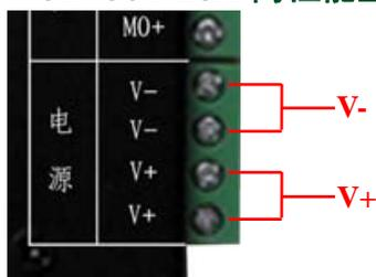
图 2.4 负载电流 10A 以上的电源接法
