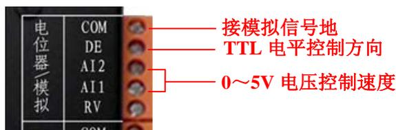
图 2.16 0-5V 模拟信号的接法(配置为双电位器调速时)
