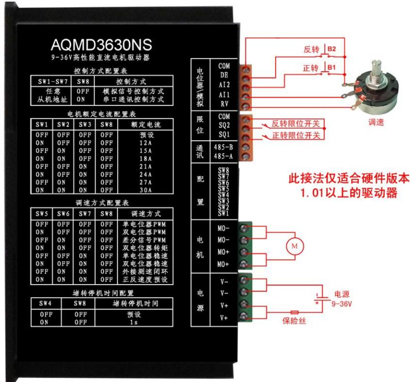
图 2.23 使用电位器调速的接线示意图
