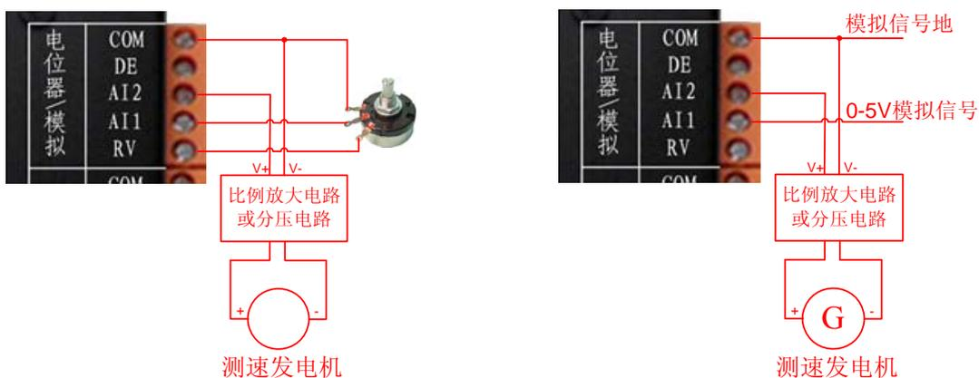
图 2.18 电位器(左图)/模拟信号(右图)外接测速发电机闭环调速接线示意图
