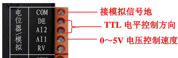
图 2.15 0-5V 模拟信号的接法(配置为单电位器调速时)
