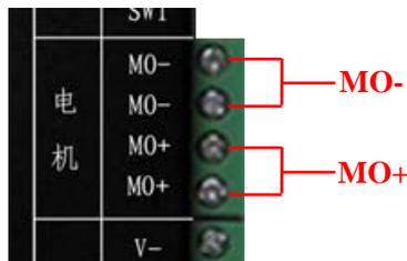
图 2.6 负载电流 10A 以上的电机接法
