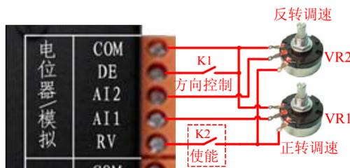
图 2.14 双电位器调速的接法
