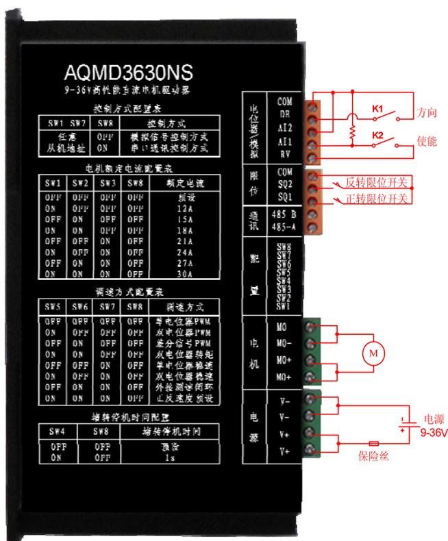
图 2.26 PWM 调速开关控制方式的接线示意图
