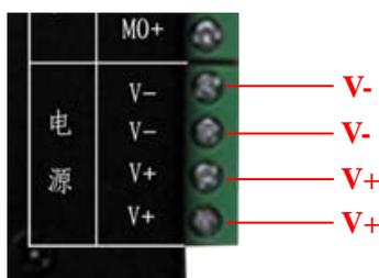
图 2.3 电源接口信号定义
