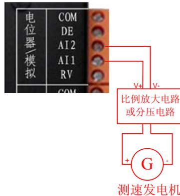
图 2.19 串口通讯控制方式闭环调速测速发电机接线示意图
