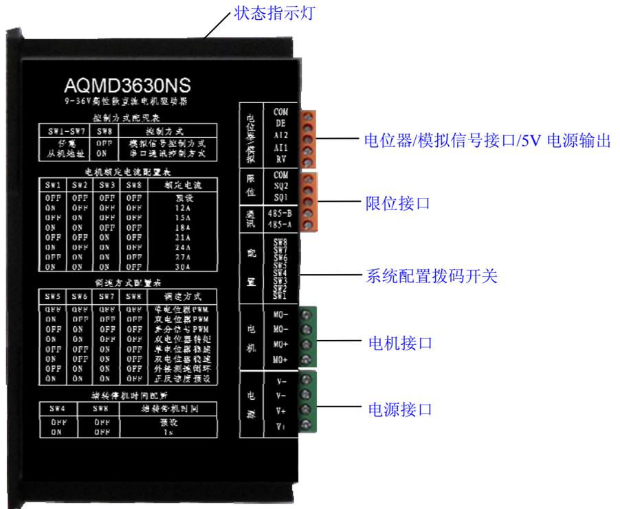
图 2.1 AQMD3630NS 电机驱动器接口定义
