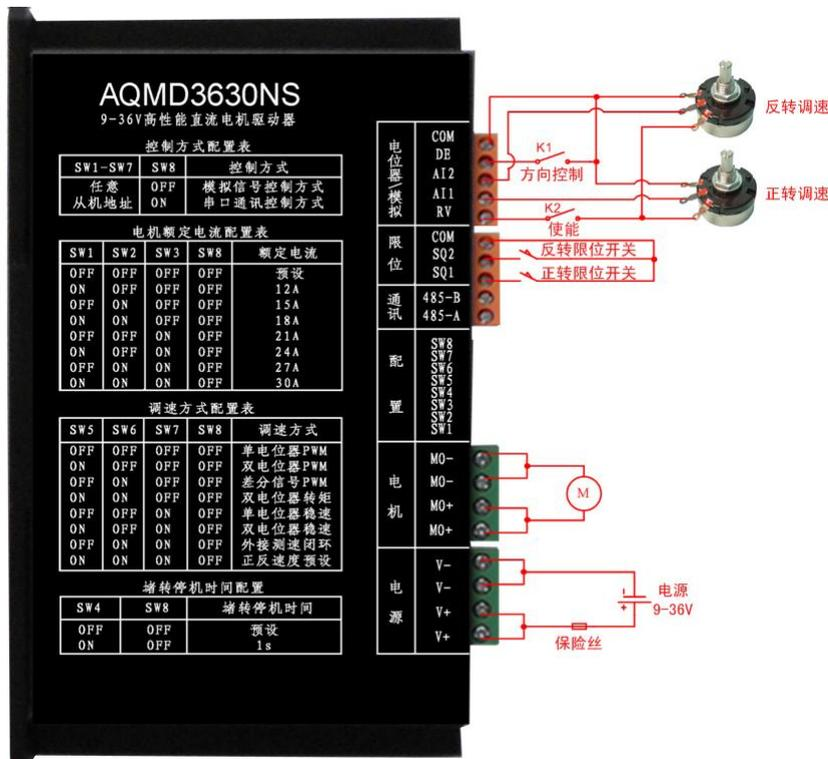
图 2.21 双电位器调速方式的接线示意图
