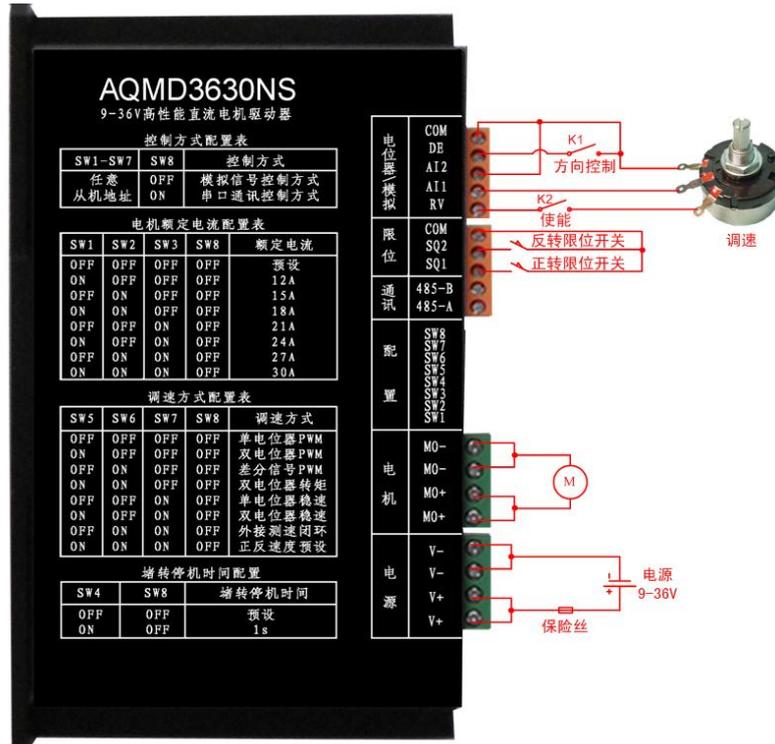
图 2.20 单电位器调速方式的接线示意图
