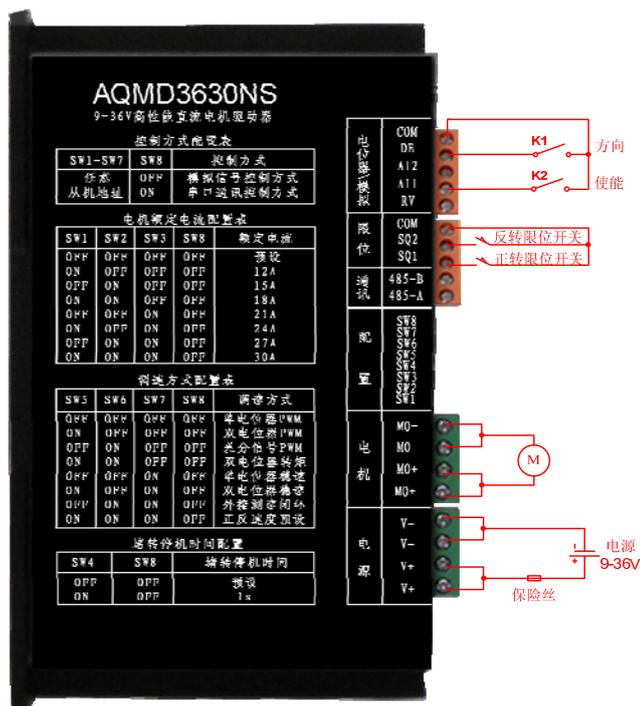
图 2.25 预设速度开关控制方式的接线示意图
