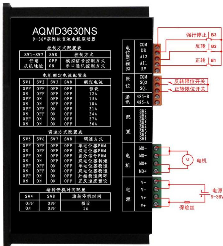
图 2.22 自保触点控制方式的接线示意图
