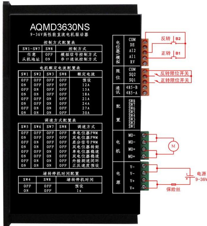
图 2.24 预设正反转速度的接线示意图
