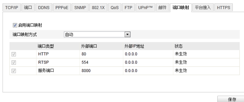
图2-35 端口映射配置
