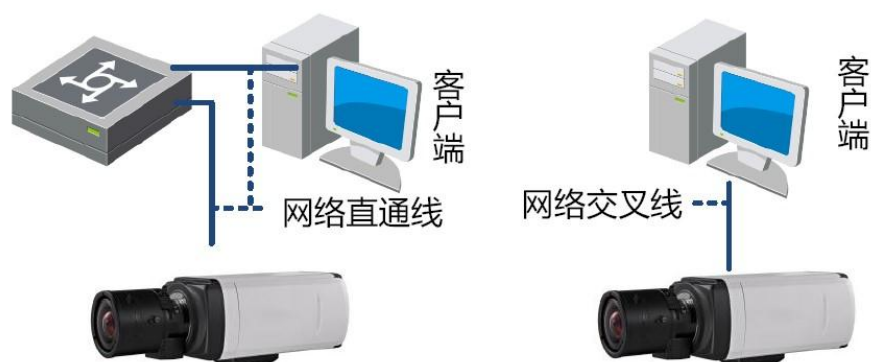
图1-1 有线网络连接示意图
