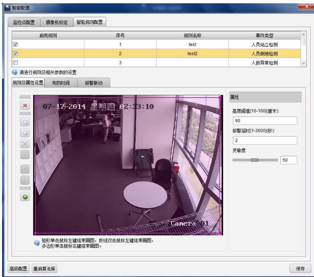
图4-28 人员倒地检测配置
