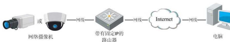
图3-1 固定 IP 通过路由器接入摄像机
