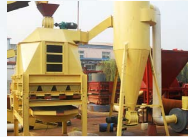
冷却机 Cooling machine
