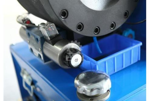
2、**电磁换向阀**：用于控制液压系统中调整介质的方向、流量、速度和其他的参数，控制的精度和灵活性都能够保证。阀芯采用德国进口 SED 专用阀芯。运行稳定，无振动，无卡芯现象。推力为 39.852N。
