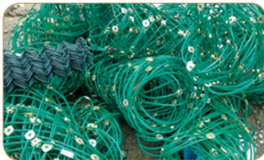
GPS2 与 GNS2 系统配置基本相同，主要区别于 GNS2 型的钢丝绳网、格栅网及缝合绳表面在热镀锌的基础上又经过了 PE 包塑处理，双层防腐，使用寿命更长，效果更佳。另外由于网片经过包塑处理之后，表皮呈现绿色，视觉冲击小，更容易融入环境，更利于绿化环保。
