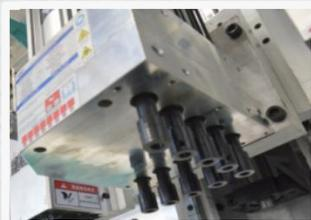
高频主轴采用高速风冷，具有高转速、低噪音，转速可高达18000RPM，精密、耐磨且可承受重切加工，气冷式内外双重强制冷却系统，可永保低温连续长时间加工，并增长主轴使用寿命。
