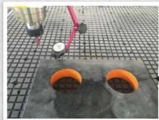
双边驱动搭配减速机，大大提升传动扭力，可使横梁高速位移时，定位重复精度精准平稳。
