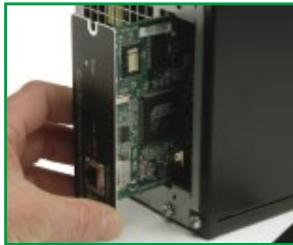
APC的附加卡可用于UPS的智能插槽内来监视电力情况，RT大于等于5KVA的产品随机附送网络管理卡。
