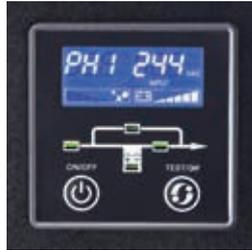
LCD 显示屏，提供关于 UPS 状态和测量值的明确信息
