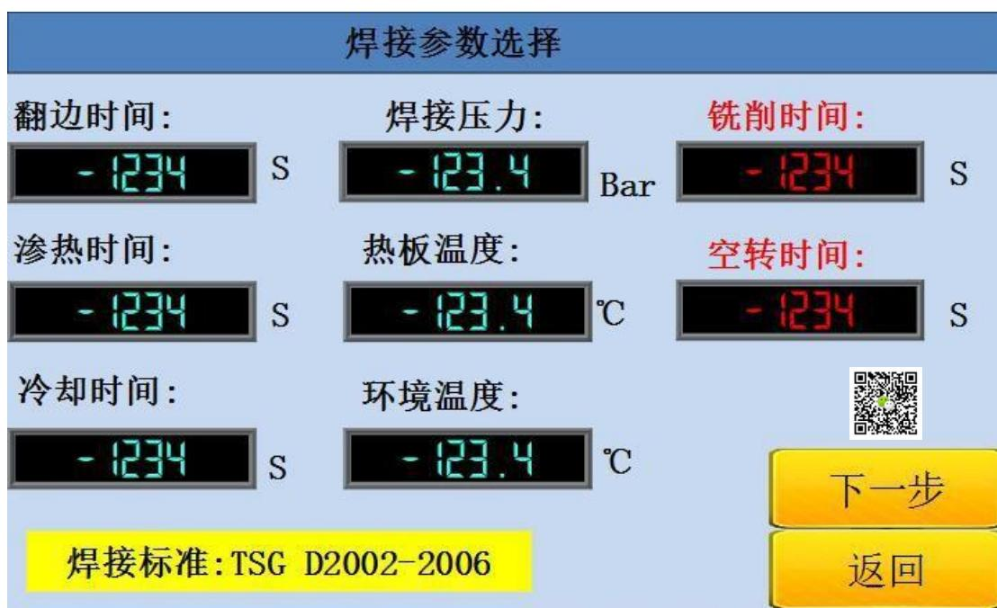
本界面显示了待焊接元件对应的具体焊接参数，这些数据是严格按照国家焊接标准设置并严禁任何个人及单位私自更改的。只有红色文字选项“铣削时间”和“空转时间”表示本次焊接中铣刀的运作时间，是可以根据具体情况进行人为调整的（点击方框后填入），以便更恰当地铣削平整待焊接元件的端口。确认后点击“下一步”。
