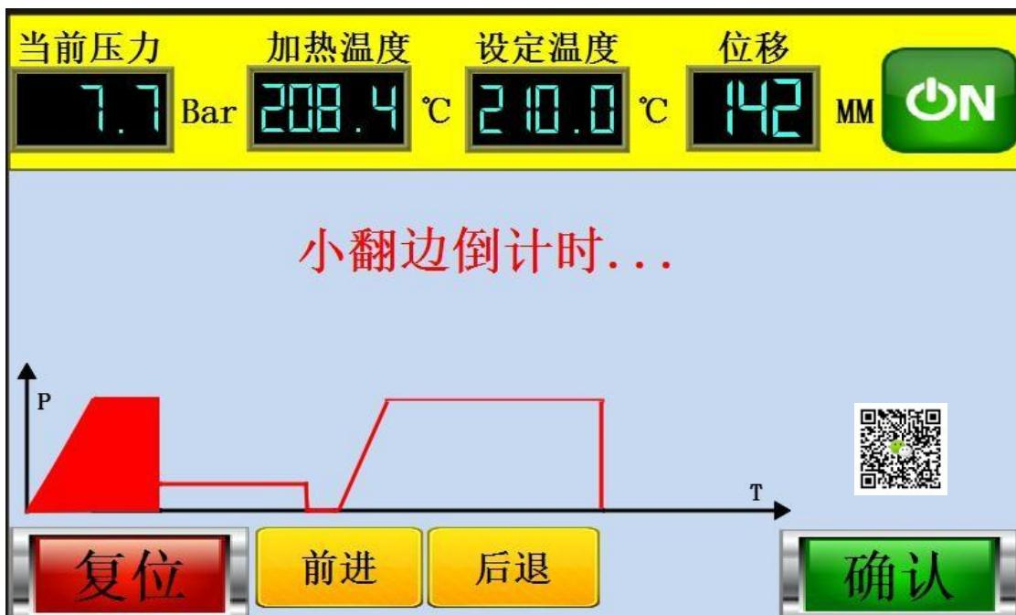
贴在热板的两个端口同时出现卷边现象，端口处物料开始进入熔化状态，待卷边达到规定要求后，系统开始渗热倒计时……
