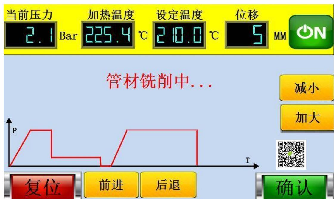
在“管材铣削中”的界面右侧有“减小”、“加大”两个按钮，用于调节铣削时移动端的驱动压力，可酌情调节。
