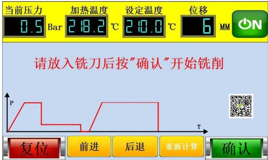
待拖动压力计算完毕后，操作界面提示放入铣刀，将铣刀正确安装在机架上，并按下铣刀电源开关，再次点击“确定”进行端口铣削作业；如下图显示：
