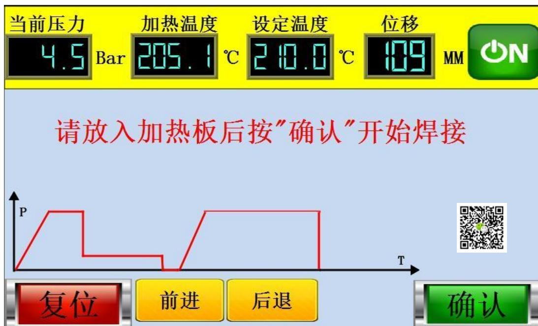
按上图界面所示要求，持热板把手将热板放入机架中（放入后须注意严禁人为地将热板碰在任何一边的端口上），再按“确认”。移动端将自动行进，使两个端口都贴在热板上；
