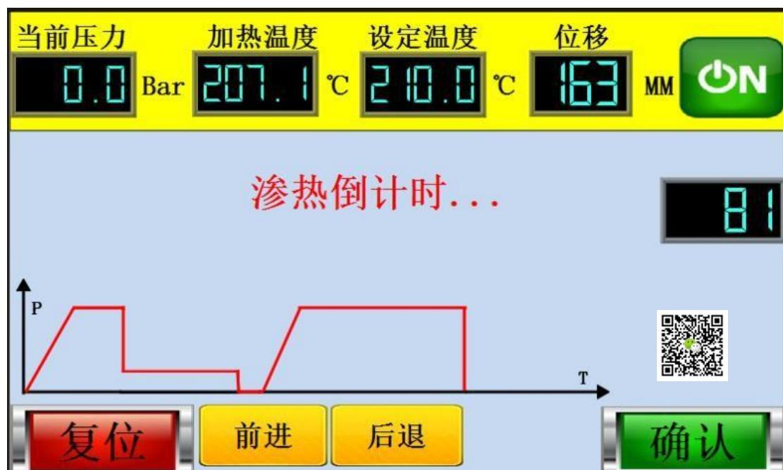
渗热倒计时结束后，机架的移动端会自动退回，同时热板自动弹起，移动端再自动对接，使得两个达到热熔标准的端口在规定压力下开始熔合在一起，并进入带压冷却倒计时……
