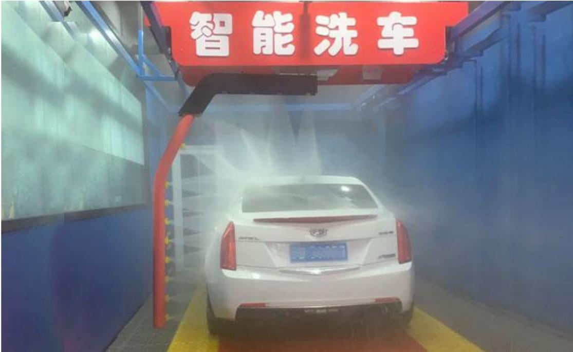
环绕型无接触是一款全自动风干一体式电脑洗车机，全自动电脑控制，采用中性免擦拭洗车液，节省人力成本的同时达到提高洗车速度、不伤车漆且环保节约的功效；行业领先的7字型喷头设计、环绕式全方位无接触冲洗，深受广大洗车用户的喜爱，大大提高了汽车服务门店的洗车业绩。
