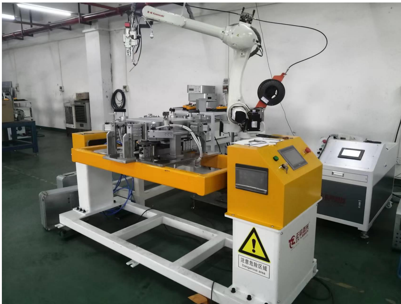
机器人焊接设备
