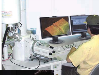
电子显微镜进行材料分析 Material analysis using an electron microscope
