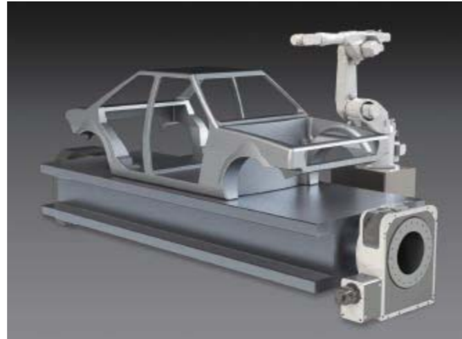
车身焊接·组工程
