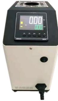
**产品用途：**ZT-LD 型零度恒温器，无需制冰，碎冰，半导体制冷，是传统冰水混合物“零点”的更新换代产品。
