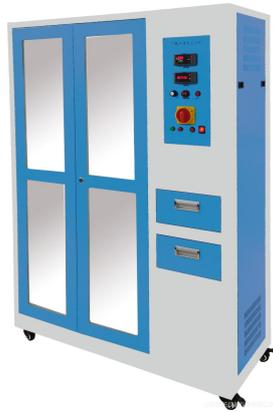
**概述：**ZT-TH 热电偶清洗退火装置是按照《JJG75-95》、《JJG167-1995》、《JJG141-2000》、《JJG668-1997》检定规程设计，对标准、工作用贵金属热电偶进行检定前的通电清洗和退火。将热电偶丝挂在专用的夹子上，通电后调节工作电流，按照检定规程规定的时间进行清洗退火。
