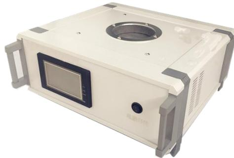
**产品介绍：**随着科技发展，接触式表面温度计大量应用在航空航天、能源、机电、化工、纺织、电力等领域，因此表面温度计的校准测量的需求也越来越多。**ZT-B308**表面温度计校验仪是由公司研发生产的新型温度校验设备，本设备根据实际需求，主要用于校准各种类型及尺寸的表面传感器，如热敏电阻，薄膜传感器，表面电阻温度计，带状温度传感器，表面热电偶等。本校验仪升降温快，40分钟内就可以从室温升至400℃；实际测试技术指标达到《JJF1409-2013 表面温度计校准规范》标准要求，与同类产品相比，均匀性优于国内外同类产品。
