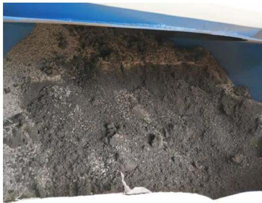
钻屑干燥机处理后油基钻屑
