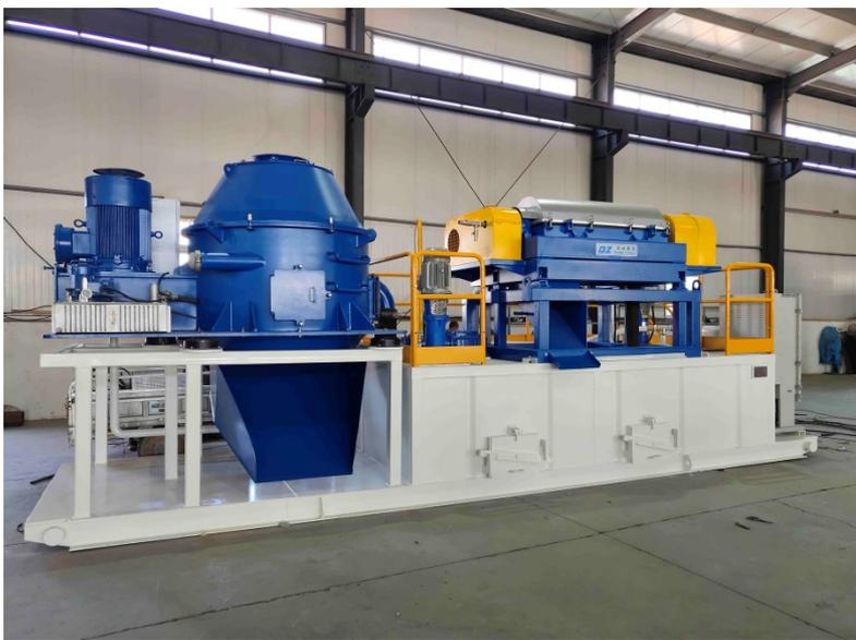
随着石油钻井开发难度的增加，在钻井时越来越多的应用油基泥浆，但是在使用油基泥浆的过程中会产生含油钻屑，对环境产生极大的危害。而且全世界绝大部分国家对含油钻屑的排放标准有严格的限制。依据地区和国家不同，对钻屑处理完的含油量要求不一样，一般要求低于5%，很多发达国家和地区要求OOC含油量低于1%。北钻公司生产的钻屑甩干机通常能够把钻屑含油量降低到3-5%。
