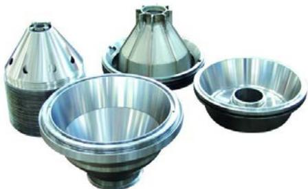
转鼓部分是碟片离心机的心脏，我们所需获得的工艺效果均由高速旋转的转鼓部分来完成的；它主要由转鼓体、转鼓盖、锁紧圈、碟片架、一组碟片等组成。转鼓上的每个零件都是分离机的关键，其关键部位均由数控机床加工而成，并有严格要求的质量保证体系控制；将这些零件精密组装后整体进行精密的动平衡试验。转鼓采用进口高强度、耐腐蚀性好的不锈钢材料经高压整体锻造成型，四次无损探伤检测，数控加工成型。确保分离机在长时间、高负载、高转速下安全可靠运行。
