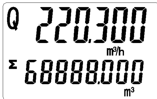
图 5-2 LCD 显示瞬时和累积流量
