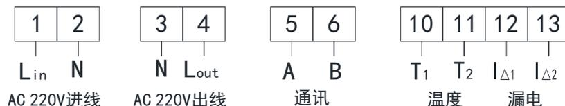
ASCP200-40B 限流式保护器接线端子图
