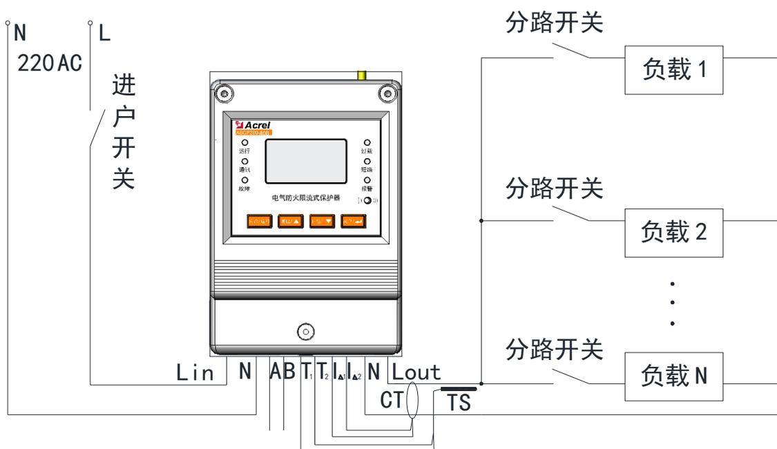
ASCP200-40B 限流式保护器的应用接线图
