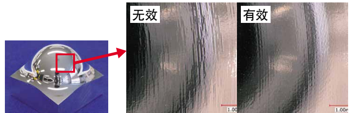
高精度程序指令的应用实例 ※指令单位为 0.1\mu\text{m} 的程序
