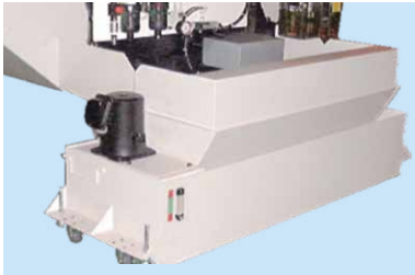
切削液装置 (水槽部分)
