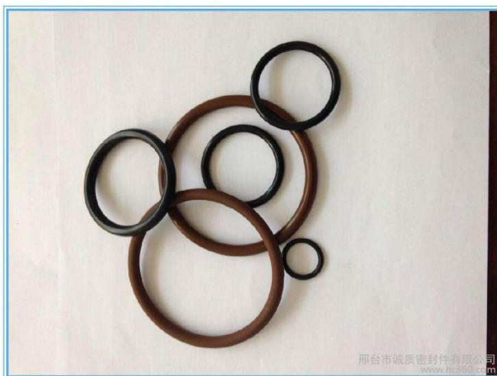
O型密封圈是流体动力系统中应用最普遍的密封形式，在许多流体动力系统中工作良好，但在作用中必须谨慎、小心。O型密封圈只有在变形时才能发挥作用。O型密封圈形如O形环，它安装在密封槽中，然后压紧，使得密封槽内没有间隙，从而封住液流或气流。尽管这种简单的密封结构在流体动力系统中密封效果良好，但只有精心设计、细心选择及恰当地安装才能实现良好的密封。
