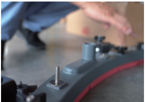
第1步:拧下吸水扒十字旋钮,通过提拉把手放下吸水扒摆尾支架;
