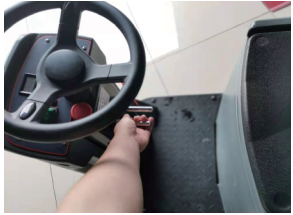
第1步:通过提拉手把放下吸水扒三角架;
