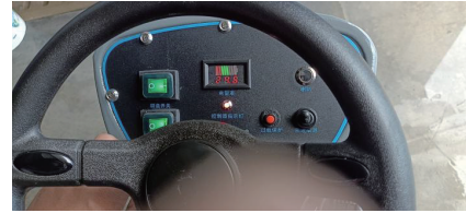
第3步:打开电源总开关,启动刷盘开关按钮、吸水电机开关按钮。
