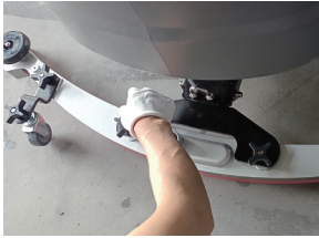
第2步:将吸水扒固定螺杆穿过三角架孔眼,使用塑料旋钮拧紧即可;
