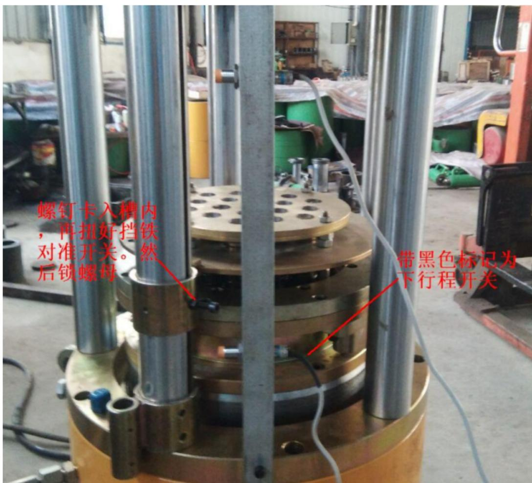
(3) 空顶调试，千斤顶联接完毕后，依次启动油泵调整好电机转向（与油泵转向相同）。然后依次安装三套自动锚接近开关和位移传感器，中锚单独一路，
