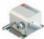
L'MBT 5410 è una sonda di temperatura per applicazioni esigenti che può essere utilizzata per controllare impianti di congelamento e temperatura del locale nell'industria generale e nelle applicazioni navali. Questa sonda di temperatura è basata su un elemento Pt100 o Pt1000 standardizzato che consente una misura affidabile ed accurata. In caso di bisogno è possibile ordinare un trasmettitore (MBT 9110) come parte integrante del sensore.
