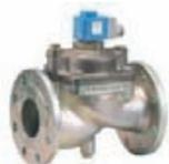
L'EV220B 65-100 è una serie di elettrovalvole a 2/2 vie per l'utilizzo in applicazioni industriali robuste e che richiedono alte portate. La valvola è progettata con un corpo valvola in ghisa e collegamento a flangia. Lo smorzamento del colpo d'ariete e un filtro pilota incorporato assicurano un funzionamento affidabile.
