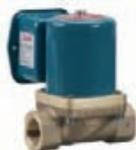
L'EV225B è un'elettrovalvola servoassistita a 2/2 vie per l'impiego negli impianti a vapore. Il progetto si basa sul concetto di una membrana in PTFE, in grado di assicurare un funzionamento altamente affidabile anche in presenza di vapore contaminato. Corpo valvola in ottone dezincolato resistente e sede valvola in acciaio inossidabile assicurano una lunga durata anche in presenza di vapore corrosivo.
