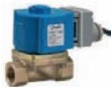
L'EV260B è una serie di elettrovalvole proporzionali (modulatrici) servoassistite a 2 vie con attacchi da 1/4" a 3/4".
