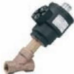
L'AV210 è una valvola ad azionamento pneumatico con sede ad angolo per applicazioni industriali robuste. La valvola può operare a temperature del mezzo e viscosità molto alte, e non è sensibile alle particelle di sporco nel mezzo; per questo motivo è spesso indicata come valvola "senza problemi". La valvola è disponibile in bronzo RG5 e acciaio inossidabile (AISI316).
