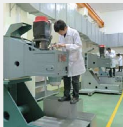
■ 主軸頭部跑合測試 (溫昇、振動、噪音)
