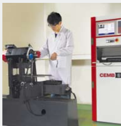
■ 主軸、主軸馬達或齒輪單元動平衡測試
