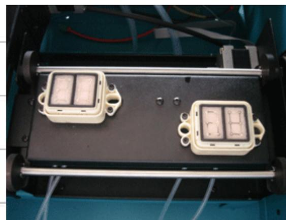
喷头密封保湿装置、自动吸墨装置（有效保护喷头、国内首创）
