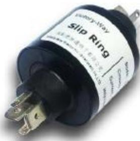
直插型滑环采用先进的贵金属排刷结构，其外径32mm，长度27.9mm下提供2路7或14安及2路2安的旋转电气通道，克服了水银滑环受环境因素影响和环保的问题。先进的工艺和可靠的结构，将接触材料的利用率达到最大，以得到最高的性价比。外部接口采用标准插头，安装方便、连接可靠。
