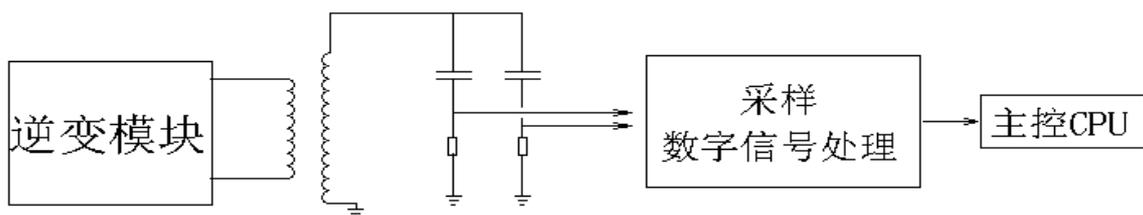
图四 介损测量原理图
