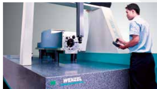
■ 加工件量測 採用高品級德系 WENZEL 三次元量測儀
