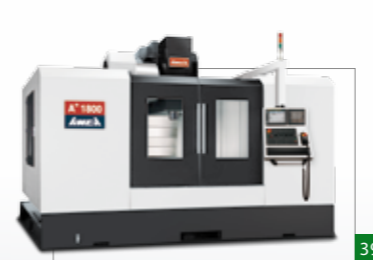
A+ 系列 高剛性立式加工機 行程 X: 850 ~ 2,500 mm Y: 600 ~ 1,000 mm Z: 600 ~ 1,000 mm
