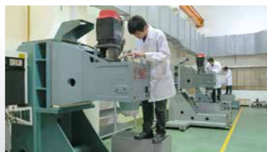
■ 主軸頭部跑合測試 (溫昇、振動、噪音)
