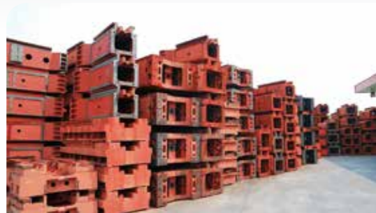
■ 鑄件時效處理 鑄件經高溫鑄造後，皆實施完整的退火程序，並經過三至六個月以上的時效處理
