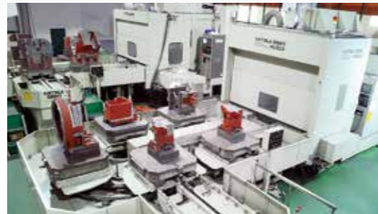
■ 鑄件加工 採用日系 MITSUI SEIKI 臥式加工機、TOSHIBA 龍門型五面加工機、臥式搪銑加工機等高精密設備
