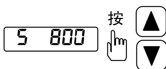
图 7.9 速度试运行操作框图
