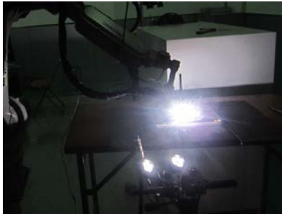
焊接变形测量现场
