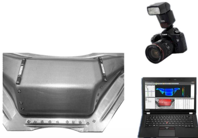
TOPSM三维板料成形变形测量分析系统，采用高分辨率单反数码相机或带有工业CCD相机的测量头拍摄冲压件图像，然后利用摄影测量的方法高精度计算多张照片中制备的小圆点空间坐标，可以获得零件的变形和应变分布，热点区域和板材的厚度变化(假定体积不变)，计算板料三维变形，生成成形极限图。该系统用于测量板料在冲压过程中的变形，测量结果以直观的色温图形式显示，可以方便地应用于对成形工艺的检验。不受测量面积限制，便携式测量，适应任何环境下进行测量，分辨率高，测量速度快，精度高。
