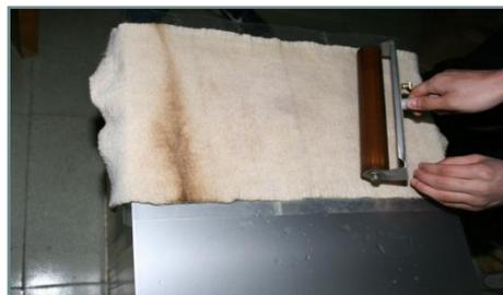
电化学方法腐蚀网格点
