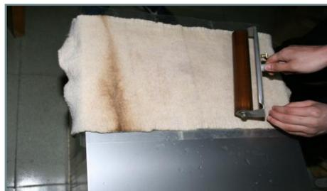
电化学方法腐蚀网格点
