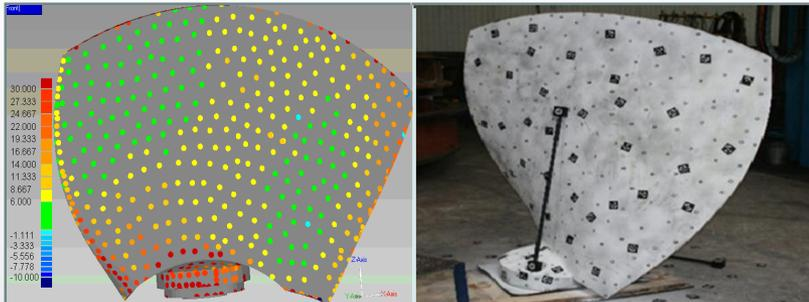
大型水轮机叶片测量现场及测量结果
