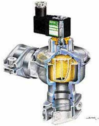
ASCO脉冲除尘阀是专为除尘设备的应用而设计，具有高流量，长寿命（高达2百万次的开关动作）和快速开/关的特点，从而保证可靠，经济的工作。阀的膜片耐磨，长寿命，（即使在相当恶劣的条件下工作）阀的压差在0.35—8.5 BAR，适合除尘器的工艺要求。口径1至3”管连接和淹没式，电源电压有230/50交流和24VDC两种。ASCO 提供防爆型，脉冲阀和成组安装的2通先导阀组。ASCO还提供控制器，差压仪，直行程和旋转气缸，空气处理三联件等。
