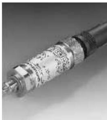
ETS 4000 温度传感器 测量范围: -25 \dots 100^{\circ}\text{C} 耐压可达600bar 标准输出信号4...20mA
