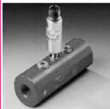
EVS 3100/3110 流量传感器，有不锈钢及铝合金两种材料。 测量范围从1.2...600 l / min， 耐压可达 400bar 标准输出信号 4...20mA
