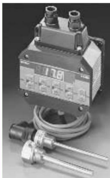
ETS 1700 4 点温度开关量并带 1 模拟量输出，4 位可调整数字显示继电器。开关点及回程开关滞后值由触摸按键调整。
