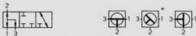
3 通球阀, T形, 90° 换向, 定位在 45°, SO 379
