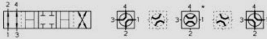
4 通球阀, X形 90° 换向, 定位在 45°, SO 385
