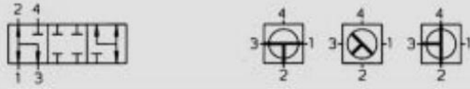
4 通球阀, T形 90° 换向, 定位在 45°, SO 389
