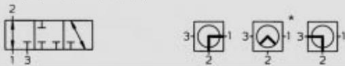
3 通球阀, L形, 90° 换向, 定位在 45°, SO 378
