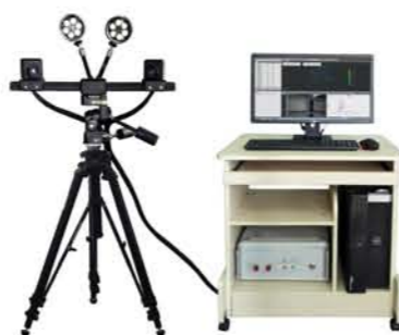
三维动态变形测量系统
