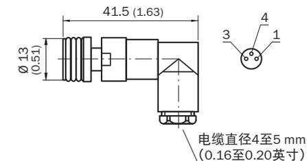
公插头尺寸图 (可直接安装)
