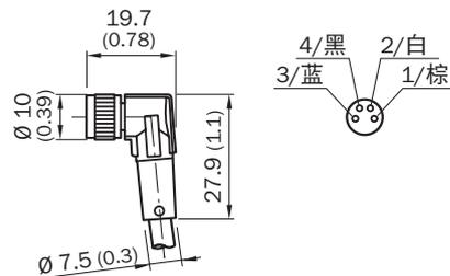
母插头尺寸图 (可直接安装)
