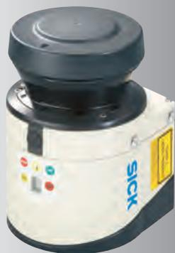
LMS111系列是SICK推出的一款紧凑型，经济型，主要用于室外区域防撞、测量及安防的激光扫描器。LMS111同西克其他扫描器一样，采用成熟的激光-时间飞行原理，非接触式检测，且加入了最新的多次回波检测技术（两次回波），使得LMS111即使在恶劣环境下也能准确测量。LMS111的主要特点为：Ip67的防护等级，雾气校正功能及内部集成加热器，保证其能用于户外，大监控范围（270°的扫描角度），灵活的区域配置（可以根据现场需
