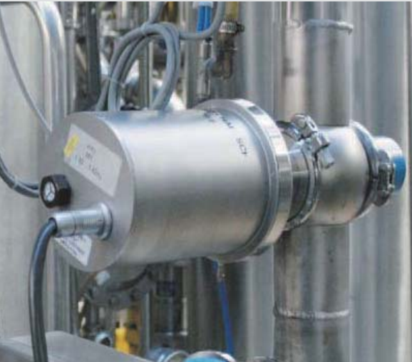
直接安装在管道上并带有超声波清洗装置
