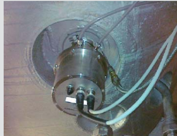
安装在结晶罐壁上 (使用T法兰)
