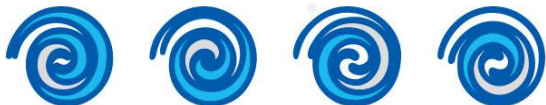
0° 气体从外缘被吸入 90° 气体在气腔内被压缩 180° 气体被压缩至排气口 270° 气体被压出排气口
