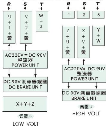
(2) 單相馬達/剎車器接線方式 (SINGLE PHASE MOTOR W/ BRAKE UNIT DIAGRAM)
