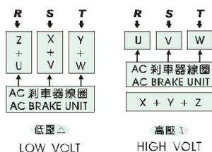
(d) 三相九條馬達電源線附交流剎車器 (NINE WIRES W/ AC BRAKE UNIT)
