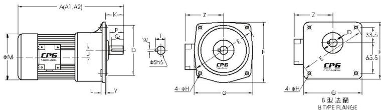
出力軸尺寸 OUTPUT SHAFT
