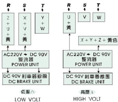
(f) 九條馬達電源線附直流剎車器 (NINE WIRES W/ DC BRAKE UNIT)
