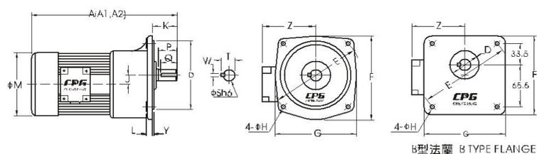
出力軸尺寸 OUTPUT SHAFT
