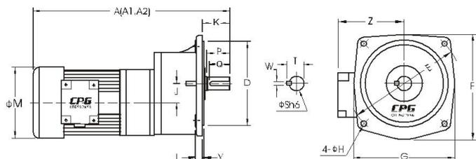
出力軸尺寸 OUTPUT SHAFT
