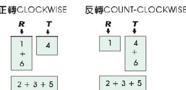
(c) 單相低壓110V附直流剎車器 LOW VOLTAGE 110V WITH DC BRAKE UNIT
