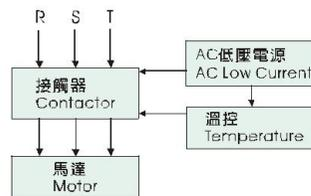
(b) 單相馬達加溫控接線圖 1-PHASE THERMOSTAT WIRING DIAGRAM
