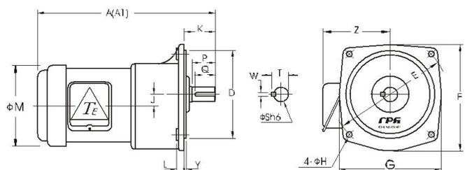
出力軸尺寸 OUTPUT SHAFT
