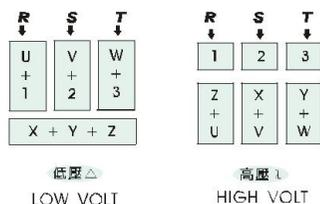
(c) 三相六條馬達電源線附交流剎車器 (SIX WIRES W/ AC BRAKE UNIT)
