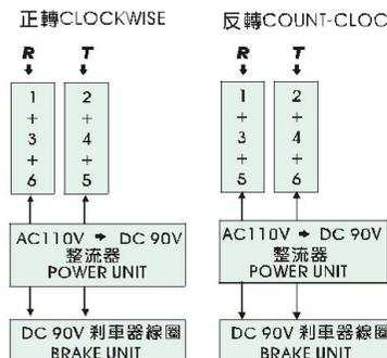
(d) 單相高壓220V附直流剎車器 HIGH VOLTAGE 220V WITH DC BRAKE UNIT
