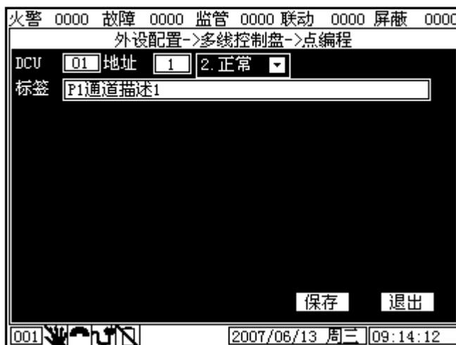
图 5-17多线控制盘点编程界面
