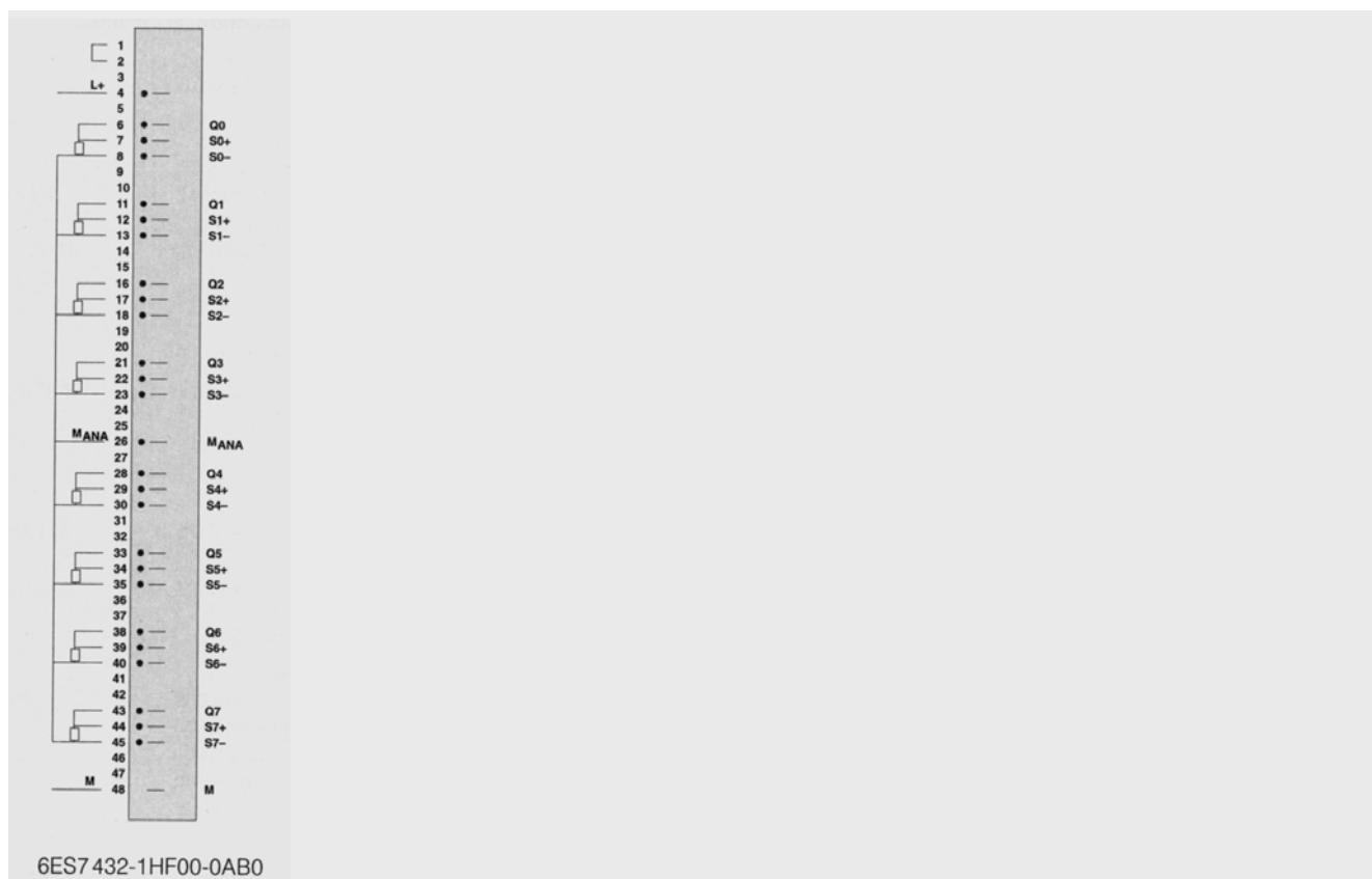
图 20 模拟量输出模板的端子接线图
