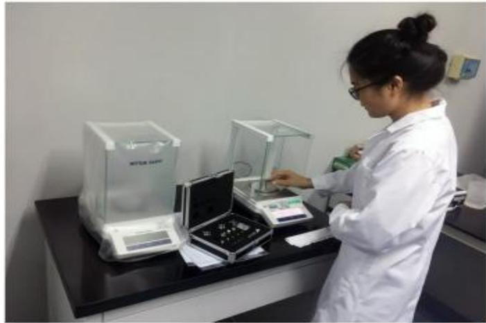
力学实验室配备有标准硬度块、0.1级标准测力仪、E2等级标准砝码组、F1等级标准砝码组、M1等级标准砝码组、二等密度计、0.02级系列数字压力计等专业设备。可开展硬度计、工作测力仪、万能试验机、衡器类、工作压力表，精密压力表，压力传感器和密度计类等计量器具的校准项目。
