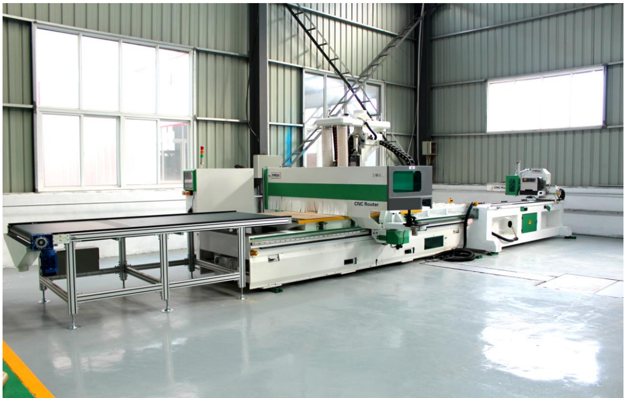
P5 重型自动贴标数控排钻开料中心(自动贴标快速切割下料)
