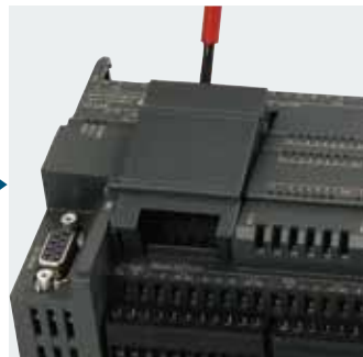
用螺丝刀卸掉空盖板
