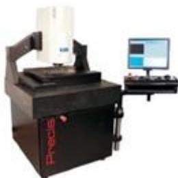
Precis 200 光学关键尺寸测量系统，主要应用于微器件，晶圆，掩模板，MEMS 和 HDD 针头。Precis 结合精密平台，光学显微镜以及 3 个世界一流的软件包，使其拥有全新的更高级的性能。Precis 在测量晶圆，掩模板和微结构上能提供亚微米视场以及点对点的测量精度。
