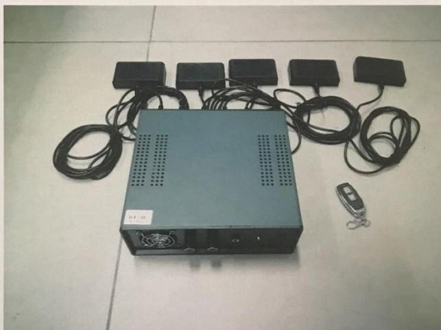
图一：YX-007-FX 型分布式录音干扰器（屏蔽器）外观
