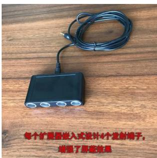
单个扩展器的屏蔽距离：1-2 米（不同的录音设备有差异）扩展器和主机标配线长 3 米，完全可以满足一般的场景需要，系统工作时主机在线长允许的情况下可以任意摆放位置。
